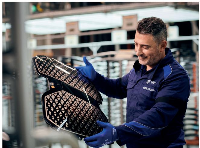
Die erste Serienanwendung für das kombinierte Folienhinterspritzen und Überfluten mit Polyurethan im anspruchsvollen Fahrzeug-Exterieur: die Nieren für den neuen BMW iX. © BMW Group
